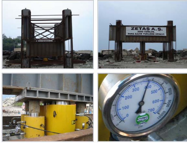
Şekil 3 Kazık yükleme deneyi düzeneği
